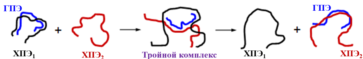
Рисунок 8-4. Механизм реакции полиэлектролитного обмена/замещения (схематическое представление).
