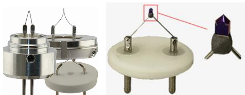
Рисунок 4. Фотографии катодов из вольфрама (слева) и LaB 6 (справа).
