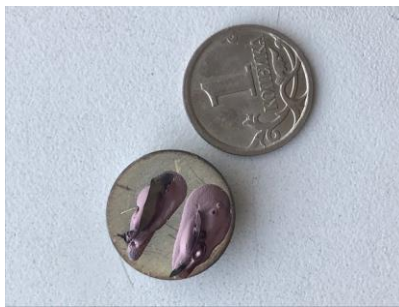
Рисунок 22. Фотография микроскопического столика с образцами для СЭМ. Для понимания масштаба фотографии сделаны вместе с однокопеечной монетой.
