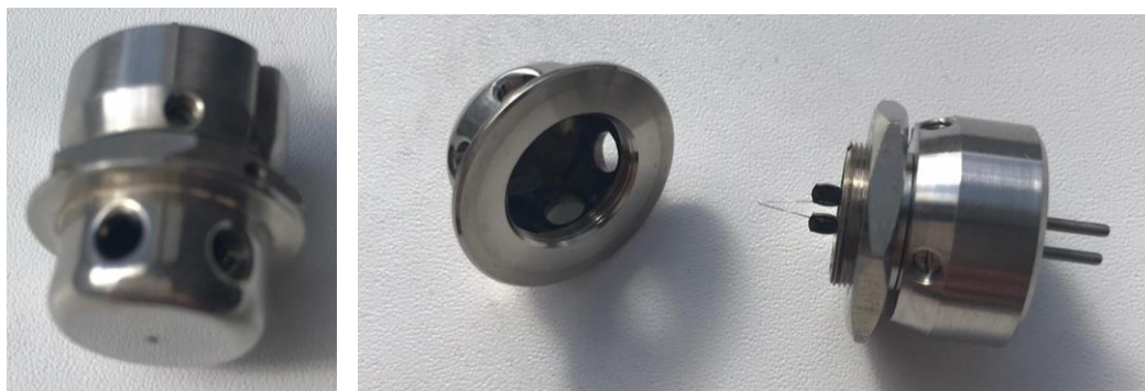
Рисунок 5. Фотографии катода для СЭМ в собранном виде (слева), готовом к размещению в электронной пушке, а также в разобранном виде (справа), где можно отдельно увидеть устройство цилиндра Венельта и катод из вольфрама.
