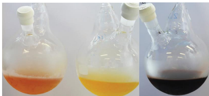
Рисунок 5.2. Окраска живых макроанионов (слева направо) полистирола, полиизопрена и поли-2-винилпиридина.
