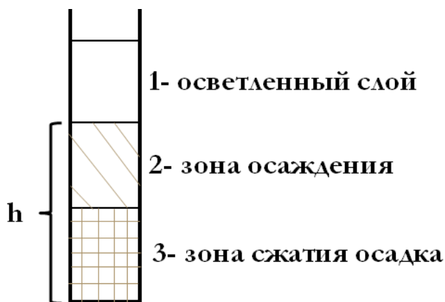
Рис. 11.5. Схема процесса сгущения.
