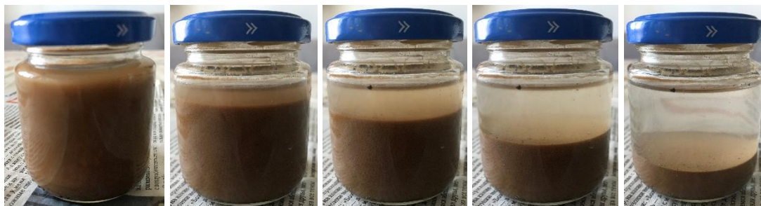
Рис. 11.4. Флокуляция и осаждение глинистой суспензии под действием раствора полимера.
